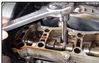
Chave Torx E14 com 140 mm e encaixe de 1/2" para parafusos do cabeçote dos motores Peugeot/Citroën 1.6 16V (TU5JP4) 2.0 16V (EW10J4/10A).
