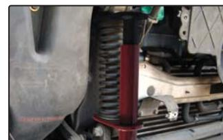
Encolhedor dos conjuntos de mola e amortecedor da cabine dos caminhões Mercedes-Benz Axor, utilizado na remoção e instalação dos mesmos.
