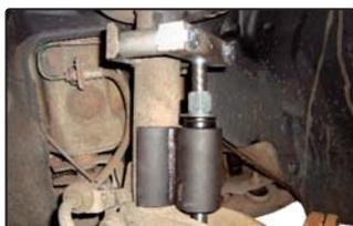
Ferramenta para desacoplar o amortecedor dianteiro da manga de eixo nos veículos Renault Mégane/Grand Tour (a partir de 2006) e Grand Scénic.
