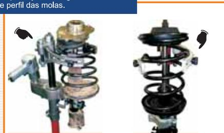
Ajuste de inclinação da coluna em relação ao equipamento.
