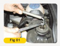
1- Para apertar ou soltar a porca de 22 mm de fixação do "prato" superior do amortecedor use a chave 113116 e uma chave allen 7 mm.
