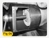
Nota 1: Observe a posição da bucha original pois a nova bucha deverá ser instalada na mesma posição. A bucha possui uma aba chanfrada voltada para um dos lados do suporte. Ao instalar a nova bucha, certifique-se que o chanfro de metal fique na mesma posição. Este procedimento garantirá a conservação da vida útil da nova bucha.
