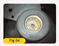
4- Com o carro apoiado totalmente ao chão, a porca de 22 mm de fixação do prato superior deverá ser fixada manualmente com a chave 113116 (o aperto é de 7 Kgf.m). Uma chave allen de 7 mm deverá ser utilizada para imobilizar a haste do amortecedor.
