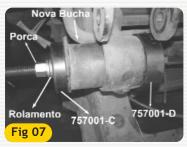
2- Utilize uma chave estrela de 19 mm e outra de 22 mm para instalar a bucha nova da cabine. Preste atenção à posição da aba chanfrada da bucha. (Fig. 08)
