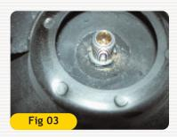
3- A porca de fixação do coxim do amortecedor, onde é utilizada a ferramenta 113096, deverá ser apertada até seu curso final com a mola comprimida. O aperto é de 4 kgf.m. Fig.03.
