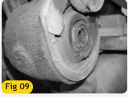
4- Com a(s) bucha(s) instalada(s), abaixe cuidadosamente o macaco garrafa e posicione a cabine, alinhando os furos dos suportes de fixação da bucha com o furo central desta. Instale o parafuso atravessando os suportes e a bucha. Utilizando duas chaves estrela de 24 mm, aperte-o. Feito isto, instale a grade de proteção e abaixe o capô do veículo.
