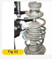
2- Durante a (des)montagem do conjunto, comprima a mola de forma que o coxim superior do amortecedor fique totalmente livre. Desta forma a chave 113096 sofre menor esforço para soltar a porca, já que o conjunto está aliviado, sem a pressão da mola. Neste processo pode ser utilizado o encolhedor Raven 113081 manual ou o 103300 pneumático. Fig 02.
