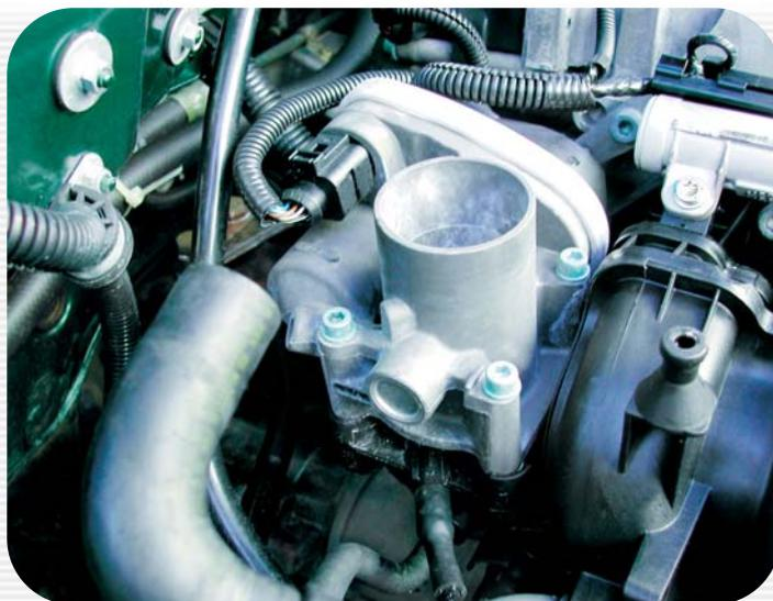
borboleta. Na remontagem do corpo deve-se, portanto, adotar o procedimento de ajuste básico através do Scanner II, restabelecendo a referência correta para o módulo. Este procedimento foi adotado, porém os solavancos continuaram.
