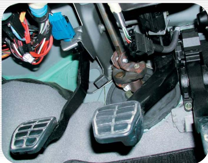
não interferirá no funcionamento do veículo. Haverá apenas a indicação da anomalia através da luz EPC no painel. Por eliminação restava ainda testar o sensor do pedal de embreagem. Num sistema convencional, ao pisarmos na embreagem, o disco é desacoplado e o motor fica momentaneamente sem carga.
