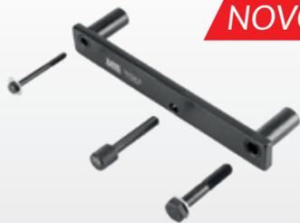
Ferramenta para manter a polia da árvore de manivelas corretamente posicionada (e também o contrapeso da polia dos motores 1.0) durante a instalação do parafuso da polia. Aplicação: motores Fiat / Stellantis GSE 1.0 12V (3 cils.) MultiAir turbo T200 aplicados nos Fiat Pulse (21>) e Fastback (22>) e 1.3 16V MultiAir turbo T270 aplicados nos Fiat Toro (21>), Fastback (22>) e Pulse Abarth (22>) e nos Jeep Renegade (22>), Compass (21>) e Commander (21>). Acompanha 2 parafusos e arruelas.
