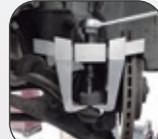
Extrator de terminais de direção e braços Pitman de automóveis e utilitários. Possui construção robusta e sistema exclusivo que faz com que as garras tendam a não abrir e a ficar no centro da ferramenta. Abertura das garras: 56 a 110 mm. Patente requerida.
