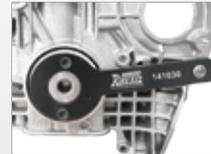
b) Instalar a ferramenta 141030 na extremidade traseira da árvore de manivelas e do bloco do motor.
