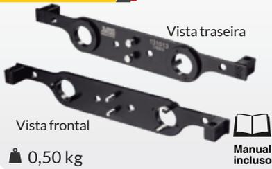
Ferramenta para travar as engrenagens das árvores de comando de válvulas (durante o aperto dos parafusos de fixação das engrenagens). **Aplicação:** motores GM 2.4 16V Ecotec aplicados na Captiva (08-16) e Malibu (10-13). Acompanha 2 parafusos.
