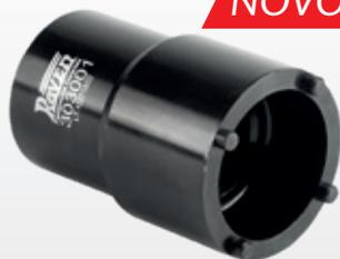
Soquete com encaixe de Ø 56 mm e 4 pinos, para porca de fixação do rolamento de roda dianteiro / porca de ajuste do cubo de roda dianteiro. Aplicação: Suzuki Jimny 3ª ger. (98-22), Jimny Sierra 4ª ger. (19>), Vitara 1ª ger. (91-99) / Sidekick (91-96), Samurai (com molas dianteiras helicoidais) (96-99) e Grand Vitara 2ª ger. (98-03) e Chevrolet Tracker 1ª ger. (99-09). Encaixe de 3/4".
