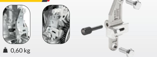
Ferramenta (com dupla função) para posicionar em sincronismo a árvore de manivelas (através do volante do motor) e para travar o volante do motor. **Aplicação:** motores GM 1.0 12V (3 cils.), 1.0 12V (3 cils.) turbo e 1.2 12V (3 cils.) turbo Ecotec / CSS Prime aplicados no Onix 2ª ger. 1.0 (19>) / 1.0 turbo (19>), Onix Plus (sedan) 1.0 (19>) / 1.0 turbo (19>), Montana 3ª ger. 1.2 turbo (22>) e Tracker 3ª ger. 1.0 turbo (20>) / 1.2 turbo (20>). Acompanha pino, 2 parafusos e arruelas.
