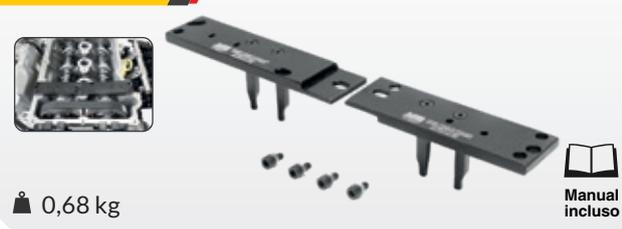
Ferramenta para posicionar em sincronismo as árvores de comando de válvulas. **Aplicação:** motores GM 1.0 12V (3 cils.), 1.0 12V (3 cils.) turbo e 1.2 12V (3 cils.) turbo Ecotec / CSS Prime aplicados no Onix 2ª ger. 1.0 (19>) / 1.0 turbo (19>), Onix Plus (sedan) 1.0 (19>) / 1.0 turbo (19>), Montana 3ª ger. 1.2 turbo (22>) e Tracker 3ª ger. 1.0 turbo (20>) / 1.2 turbo (20>). Acompanha 4 parafusos e porcas.
