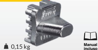
Ferramenta para posicionar em sincronismo as árvores de comando de válvulas (através das polias). **Aplicação:** motores GM Família I 1.0 16V, 1.6 16V (X16XE) e 1.8 16V aplicados no Corsa / Corsa Sedan / Corsa Wagon 1.0 16V, Corsa GSI 1.6 16V, Corsa Sedan / Corsa Wagon 1.6 16V, Meriva 1.8 16V e Tigra 1.6 16V e no Fiat Stilo 1.8 16V.
