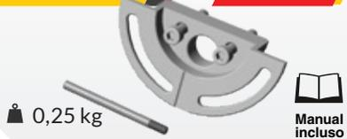
Ferramenta para manter a engrenagem da bomba d'água travada e corretamente posicionada, durante e após a remoção da bomba d'água. Elimina o risco de perda do sincronismo do motor ao remover a bomba e a necessidade de remover diversos componentes para acessar o sistema de distribuição e então remover a bomba d'água. **Aplicação:** motores GM Ecotec 2ª ger. 2.4 16V (LEA) aplicados na Captiva (08-16) e Malibu 7ª ger. (10-13). Acompanha pino guia para facilitar a instalação da bomba d'água.
