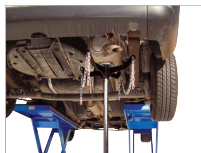
Sustentação do silenciador do escapamento para substituição dos coxins.
