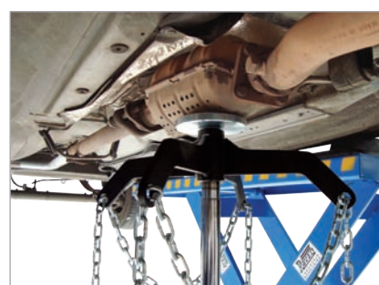
Sustentação do catalisador para substituição do escapamento.
