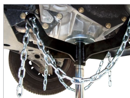
Sustentação para substituição do coxim de câmbio
