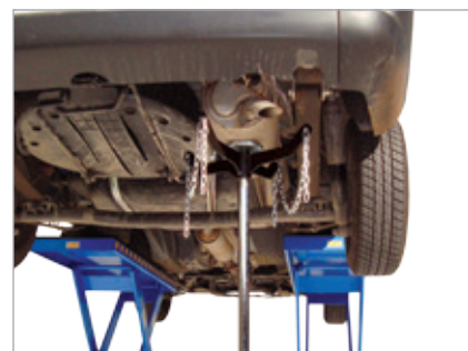
Sustentação do silenciador do escapamento para substituição dos coxins.
