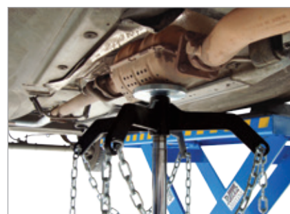
Sustentação do catalisador para substituição do escapamento.
