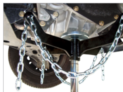
Sustentação para substituição do coxim de câmbio
